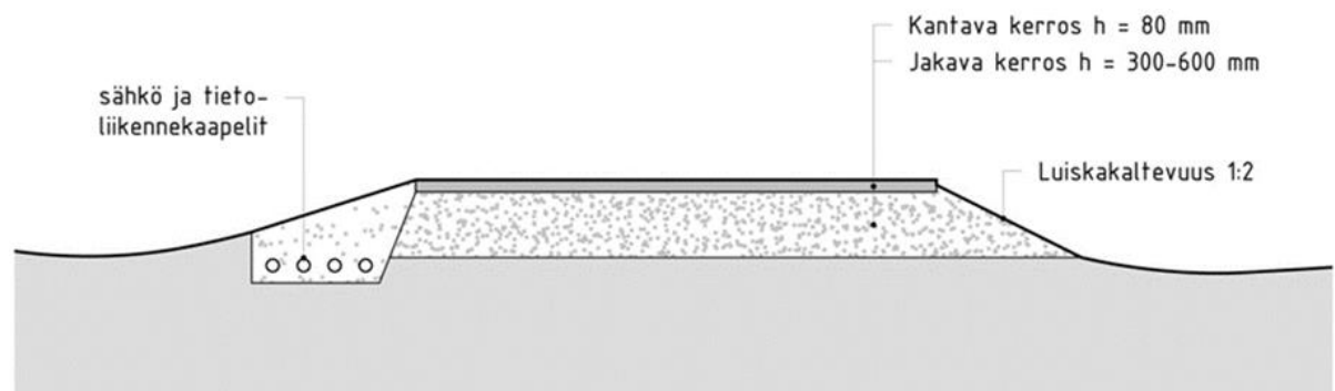
Periaatekuva uuden ja perusparannettavan tien rakenteesta.
